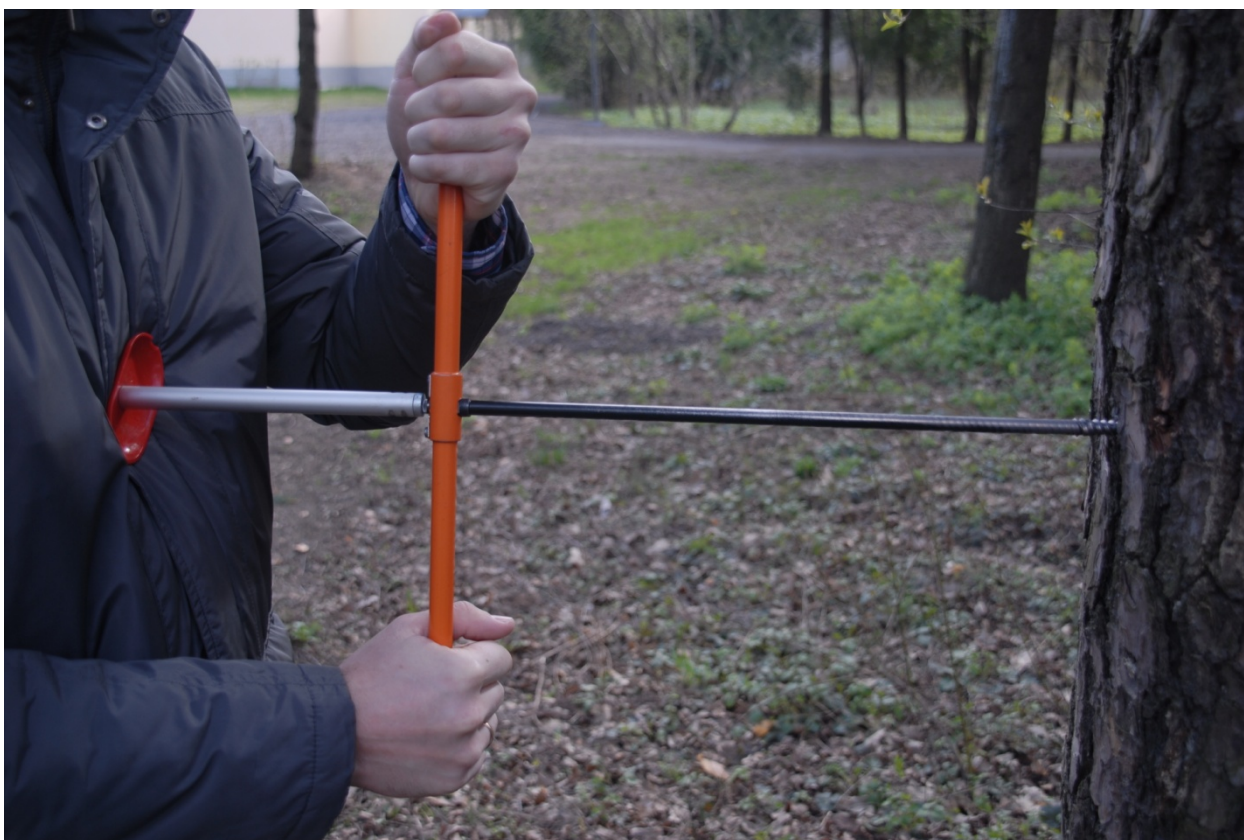
Рис. 10 Отбор образцов древесины (кернов) возрастным буравом с помощью «стартера»
