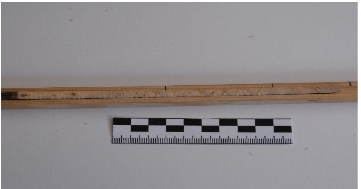
Рис.12 Керн древесины до подготовки к измерениям в подложке.
