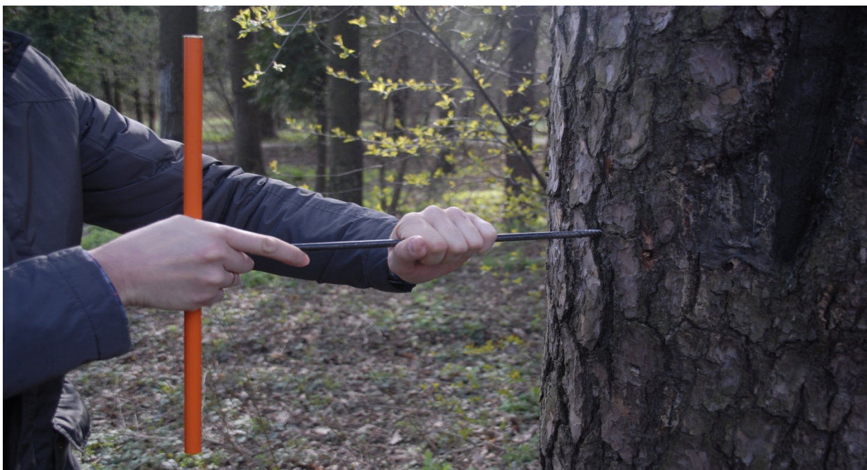
Рис. 9 Отбор образцов древесины (кернов) возрастным буравом.
